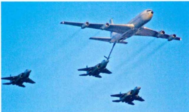
Les avions de chasse peuvent être ravitaillés en vol par un avion ravitailleur. Ce dernier, qui vole à une vitesse de l'ordre de 500 km/h par rapport au sol, envoie une perche à l'avion de chasse qui s'y accroche. Le carburant peut alors s'écouler entre les deux appareils.
