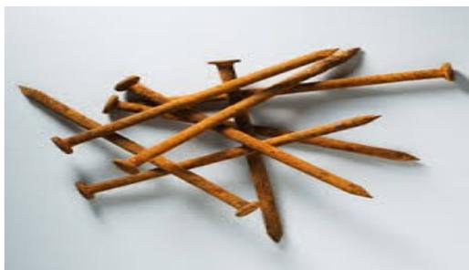
**Réactifs** : Fer ( $Fe$ , clou), eau ( $H_2O$ , humidité), dioxygène ( $O_2$ , dans l'air)
